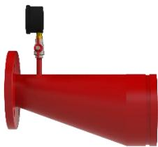
**Kit aspirazione (vers. soprabattente) DN 65/150** da installare sul lato aspirante delle pompe principali per rispettare i requisiti della norma: "diametro minimo tubazione 80 mm, velocità massima dell'acqua nelle tubazioni di aspirazione 1,5 m/s alla portata di progetto".
