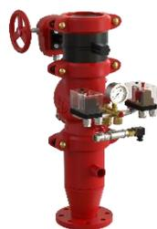
**Colonna di mandata DN 80** UNI EN 12845:2020 10.5, con accessori idraulici allargati ad un diametro che consente di mantenere velocità inferiori a quelle previste dalla norma UNI EN 12845:2020 13.2.3.
